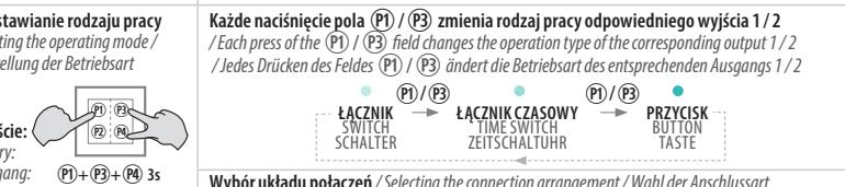
Każde naciśnięcie pola (P1) / (P3) zmienia rodzaj pracy odpowiedniego wyjścia 1 / 2 / Each press of the (P1) / (P3) field changes the operation type of the corresponding output 1 / 2 / Jedes Drücken des Feldes (P1) / (P3) ändert die Betriebsart des entsprechenden Ausgangs 1 / 2
