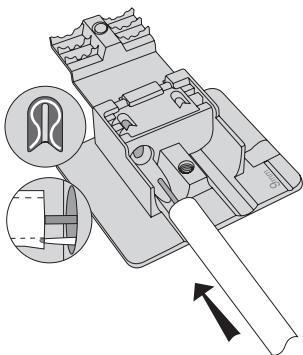
3. Wprowadzić kabel antenowy do zacisku tak, aby ostrze zacisku weszło pomiędzy ekran a izolację zewnętrzną kabla. Należy sprawdzić poprawność wprowadzenia przewodu wewnętrznego do zacisku.
