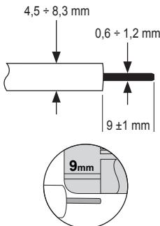
1. Przygotować końcówki kabla koncentrycznego do podłączenia - odizolować przewód wewnętrzny odcinając na tej samej wysokości izolację zewnętrzną, ekran (oplot) oraz izolację wewnętrzną - według znacznika na korpusie.
